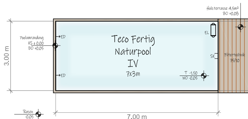
Teco-Fertig-Naturpool mit Poolumrandung (Holz)
